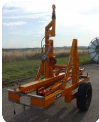
Remorque K27H : pour dérouler 2 tourets de PE en simultanément pliable pour le transport
